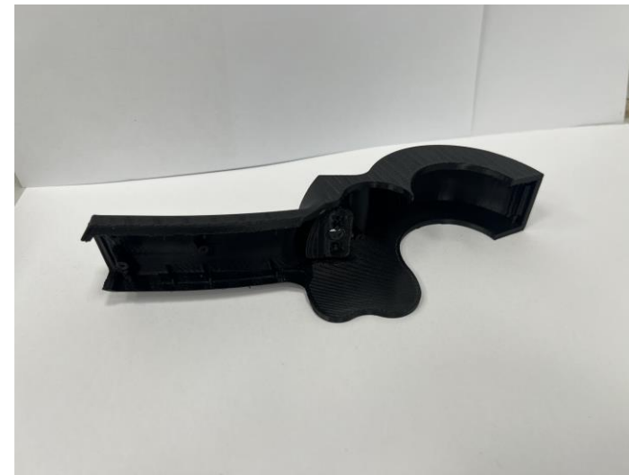
Электроизмерительное оборудование. Часть восстановленного прибора токоизмерительные клещи (Спроектировано средствами обратного инжиниринга, усилена конструкция и изготовлено из материала PETG)
