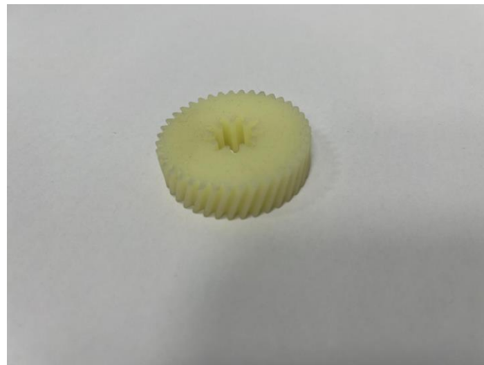
Изделия общего машиностроения. Шестерня уничтожителя бумаги (Спроектировано средствами обратного инжиниринга и изготовлено из материала Nylon 12CF)
