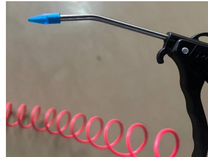
Пневматическое оборудование. Сопло на пистолет, необходимое для создания направленного потока воздуха (Спроектировано средствами обратного инжиниринга, из жидкой смолы ABS-like)
