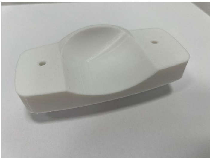
Медицинское оборудование. Подставка под подбородок для автоматического бесконтактного тонометра (Кабинет офтальмолога) (Спроектировано средствами обратного инжиниринга и изготовлено из материала PETG)
