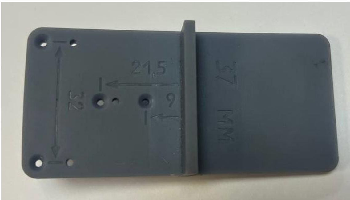
Технологическая оснастка. Кондуктор для дверных петель (Спроектировано средствами обратного инжиниринга и изготовлено из жидкой смолы типа Standart Rezin)
